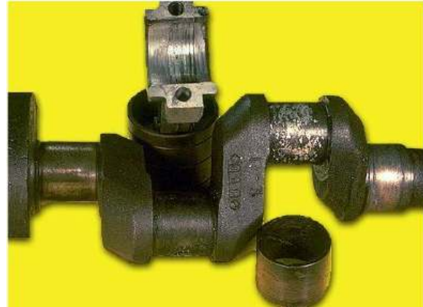
Αστοχία Άξονα από Μπλοκαρισμένο κινητήρα
