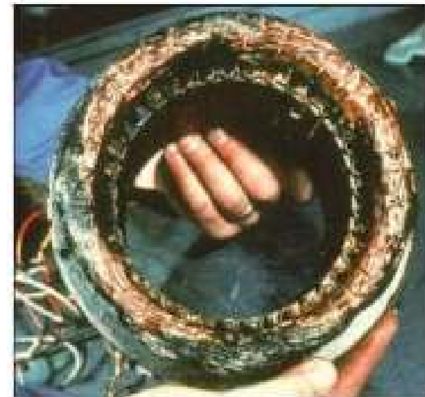
Αστοχία από απώλεια φάσης
