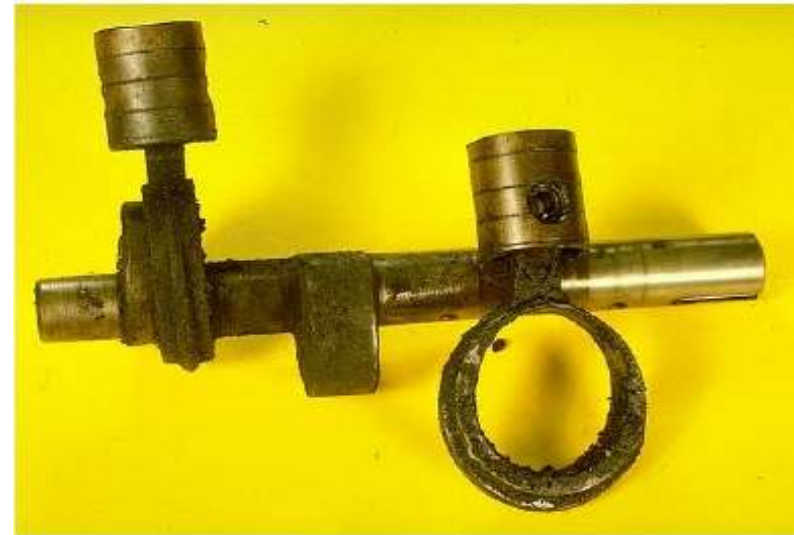
Αστοχία Άξονα λόγω Απώλειας Λαδιού
