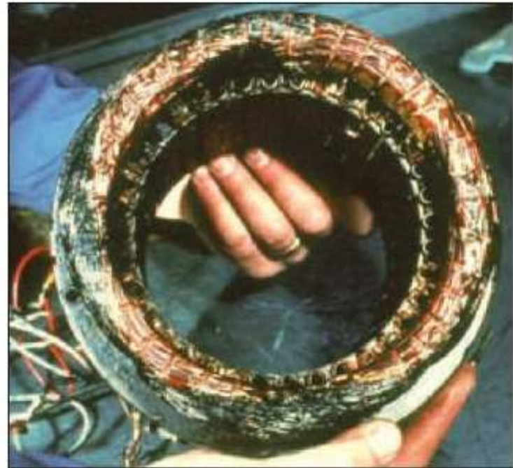
Αστοχία από πρόβλημα τάσης
